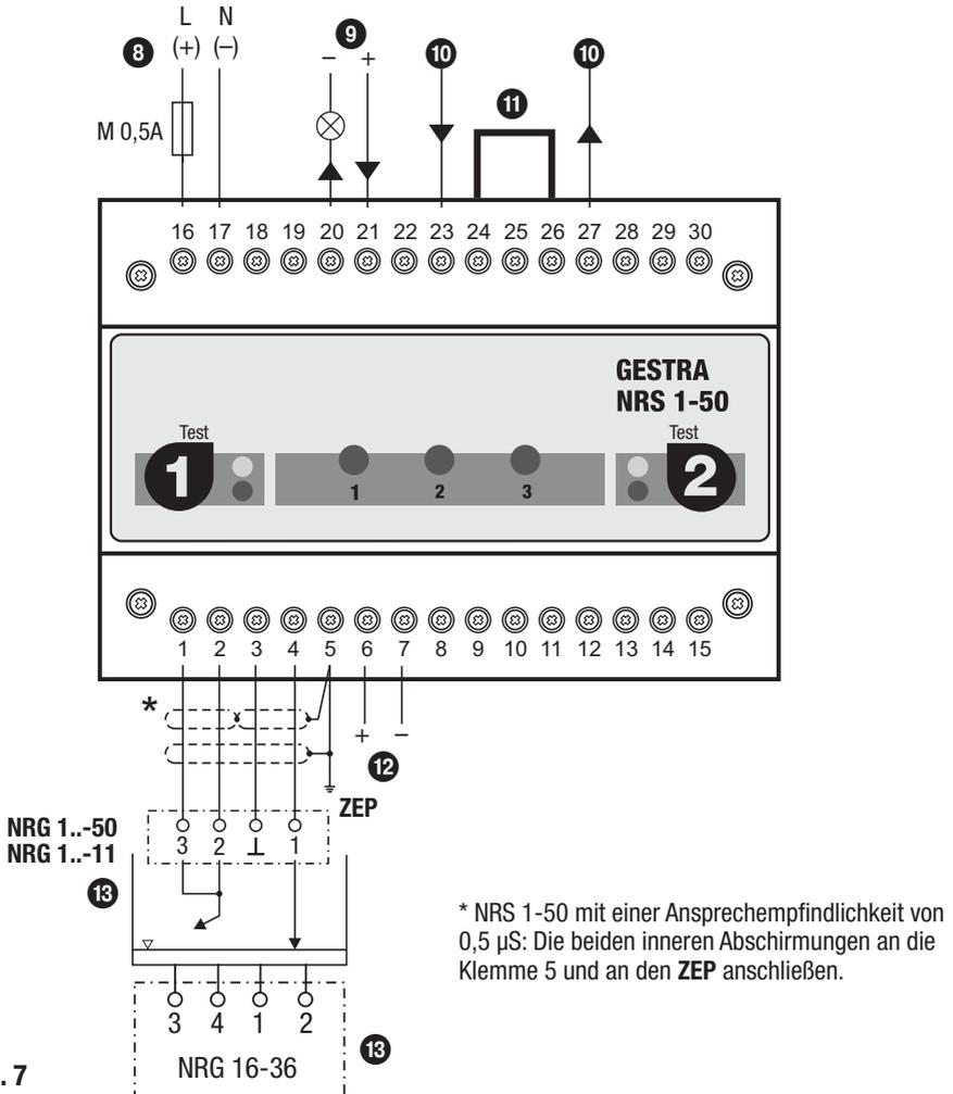
\* NRS 1-50 mit einer Ansprechempfindlichkeit von 0,5  $\mu$ S: Die beiden inneren Abschirmungen an die Klemme 5 und an den ZEP anschließen.
