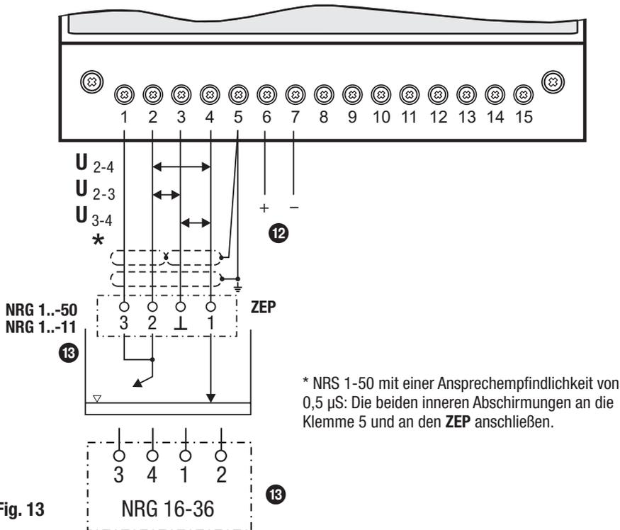
\* NRS 1-50 mit einer Ansprechempfindlichkeit von 0,5  $\mu\text{S}$ : Die beiden inneren Abschirmungen an die Klemme 5 und an den ZEP anschließen.
